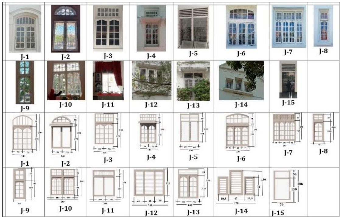
Gambar 5. Detail-detail komponen bukaan Jendela pada bangunan Museum Balee Juang (Dokumentasi: Liana, 2023)
