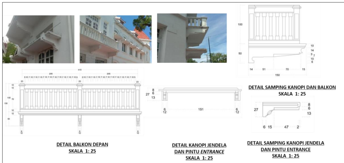
Gambar 7. Gambar foto dan struktural kanopi bangunan Museum Balee Juang (Sumber: Dokumentasi pribadi, 2023)
