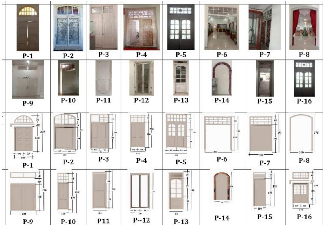
Gambar 4. Detail-detail komponen bukaan Pintu pada bangunan Museum Balee Juang (Dokumentasi: Liana, 2023)
