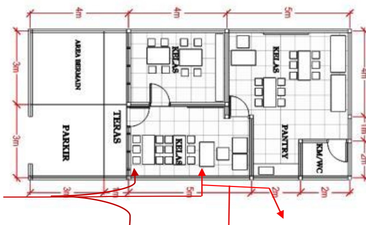
Gambar 9. Posisi ruang-ruang di PAUD Kuncup Matahari. Akses menuju km/wc dan pantry serta ke kelas-kelas melalui salah satu kelas.
